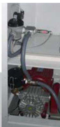
Sistema a depressione tramite pompa a vuoto
