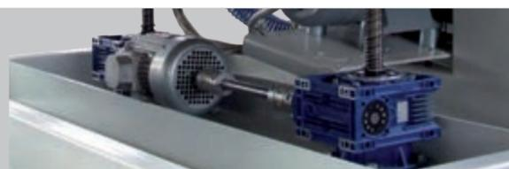
Depressore interno (taratura variabile, inverter)
