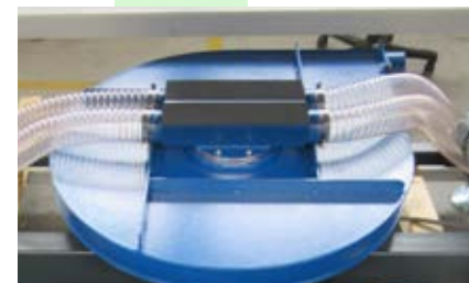
Depressore interno (taratura variabile, inverter) Internal vacuum fan (setting variable, inverter) Ventilador de aspiración del vacío interno (ajuste variable, inverter)
