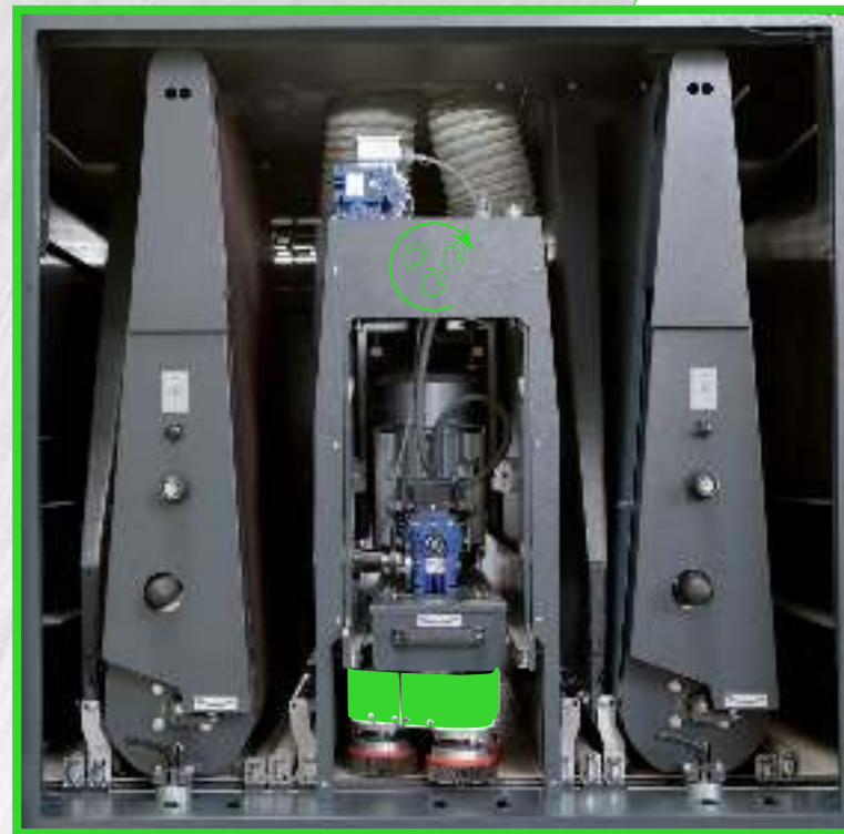
Bürstenwalze tangential / planetarisch Groupe de brosses système tangentiel / planétaire Узел тангенциальных щёток / планетарная система
