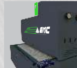
Doppelter Bürstenaggregat im Auslauf der Maschine Double brosse en sortie Двойная щётка на выходе
